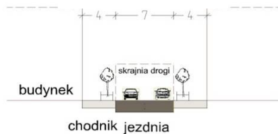
Rys. 1. Model I – wariant bez dostępu do gruntu rodzimego; wąska ulica z małymi drzewami w pojemnikach (drzewa najmniejsze - I) (wg Borowski i Pstrągowska 2009 2 )
